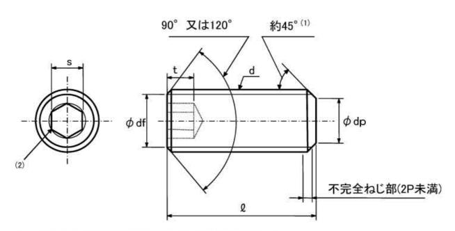
注-(1) 45°の角度は、おねじの谷の径より下の傾斜部に適用する。
